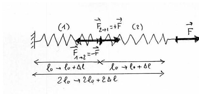
Si l'on définit une raideur équivalente par  $\Delta \ell_{total} = F/k_{eq}$ , on en déduit  $k_{eq} = k/2$  et comme par ailleurs la longueur à vide est devenue  $2\ell_0$ , on remarque que le produit de la longueur à vide par la raideur est la même pour un ressort et pour deux. Ce résultat se généralise aisément à un nombre quelconque de ressorts et permet d'affirmer que  $k\ell_0 = Cte$  notée  $K$  et d'écrire pour un ressort  $F = K \Delta \ell / \ell_0$
